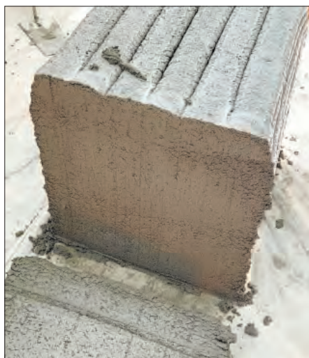
Рис. 3. Обрезка краев изделия в местах скругления печатного слоя после завершения печати Fig. 3. Trimming the edges of the product in the places of rounding of the printed layer after printing is completed
