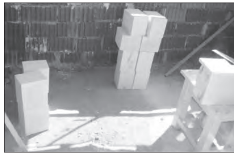
Рис. 1. Подготовка образцов-кубов и блоков из ячеистого бетона для изготовления фрагментов кладок, предназначенных для проведения испытаний на морозостойкость Fig. 1. Preparation of samples-cubes and blocks of cellular concrete for the manufacture of masonry fragments intended for testing for frost resistance
