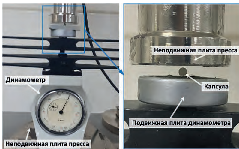
Рис. 4. Устройство для определения максимальной нагрузки капсул Fig. 4. Device for determining the maximum loading of capsules
