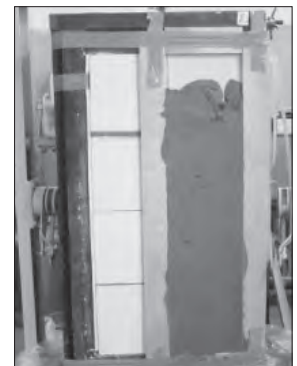
Рис. 2. При устройстве кладки в стену устанавливали датчики температуры (термохроны). Правая половина фрагмента была оштукатурена, левая — не оштукатурена. Одновременно с основными фрагментами были подготовлены контрольные фрагменты кладок Fig. 2. When laying the masonry, temperature sensors (thermochrones) were installed in the wall. The right half of the fragment was plastered, the left half was not plastered. Simultaneously with the main fragments, control fragments of masonry were prepared
