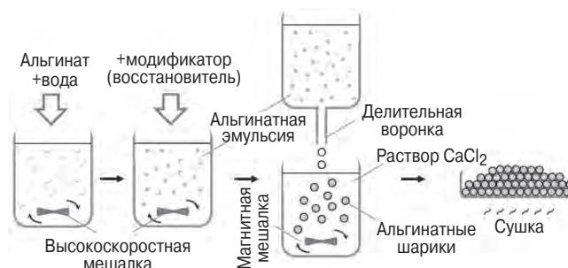
Рис. 2. Схема производства инкапсулированного модификатора Fig. 2. Scheme for the production of an encapsulated modifier
