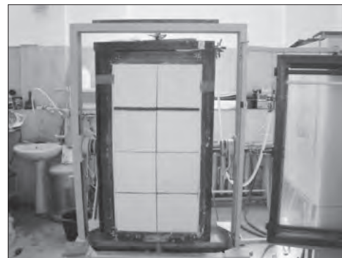
Рис. 2. При устройстве кладки в стену устанавливали датчики температуры (термохроны). Правая половина фрагмента была оштукатурена, левая — не оштукатурена. Одновременно с основными фрагментами были подготовлены контрольные фрагменты кладок Fig. 2. When laying the masonry, temperature sensors (thermochrones) were installed in the wall. The right half of the fragment was plastered, the left half was not plastered. Simultaneously with the main fragments, control fragments of masonry were prepared
