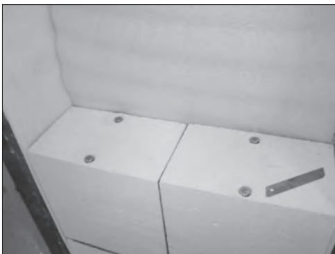
Рис. 2. При устройстве кладки в стену устанавливали датчики температуры (термохроны). Правая половина фрагмента была оштукатурена, левая — не оштукатурена. Одновременно с основными фрагментами были подготовлены контрольные фрагменты кладок Fig. 2. When laying the masonry, temperature sensors (thermochrones) were installed in the wall. The right half of the fragment was plastered, the left half was not plastered. Simultaneously with the main fragments, control fragments of masonry were prepared
