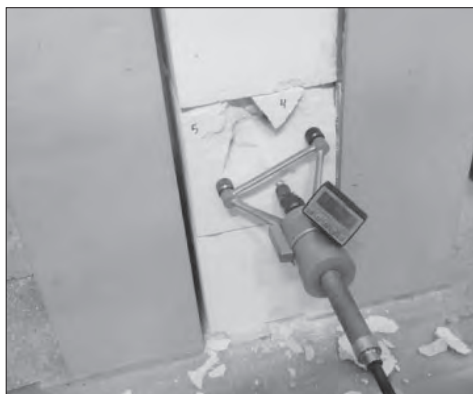
Рис. 3. Проведены испытания прочности на вырыв химических анкеров на контрольном образце фрагмента кладки и по завершении циклических воздействий
