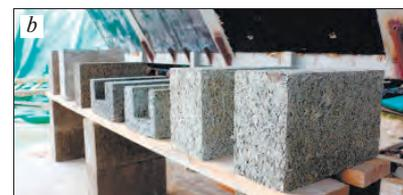
**Рис. 2.** Внешний вид изделий из бетона с добавками органического происхождения (лен, конопля): *a* – блок 600×200×300 мм ([https://images.ua.prom.st/2068300558\\_w640\\_h640\\_arbolit-stroitelnye-bloki.jpg](https://images.ua.prom.st/2068300558_w640_h640_arbolit-stroitelnye-bloki.jpg)); *b* – варианты изделий (<https://static.tildacdn.com/tild6361-3833-4261-b930-313532333431/arbolit-armoblok-8.jpg>)
