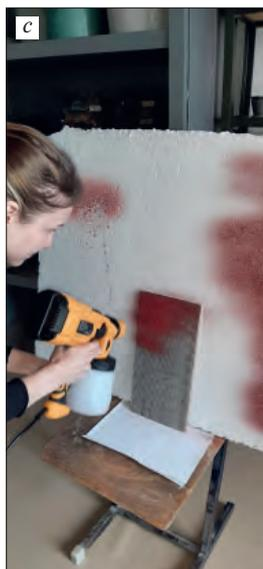
Рис. 8. Процессы приготовления и нанесения готового состава: а – гомогенизация сухой смеси в дисковом истирателе; б – перемешивание сухой смеси с водой; с – нанесение с помощью краскопульта
