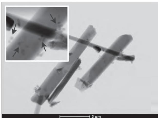
Рис. 5. ПЭМ изображения образца гипсового модифицированного камня
