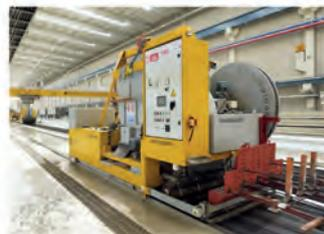
Формовочные установки NORDIMPIANTI способны производить широкий ассортимент преднапряженных железобетонных изделий таких, как пустотные плиты перекрытий, пустотные стеновые панели, ригели таврового и двутаврового сечения, столбики для винограда и перемычки, преднапряженные плиты, элементы U-образного сечения, плиты с интегрированными тавровыми ригелями и т.д.
