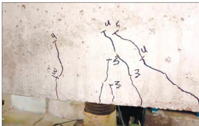
Рис. 15. Картина развития трещин в балке Б1
