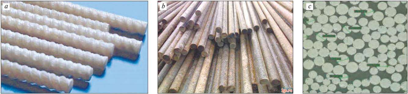
Рис. 2. Образцы ПКА, представленные на рынке РФ: а – с вдавленным профилем; б – песчаный профиль; с – микрофотография фрагмента поперечного сечения ПКА (×300)
