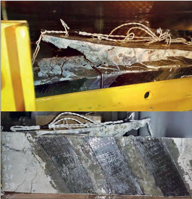
Рис. 6. Разрушение балки
