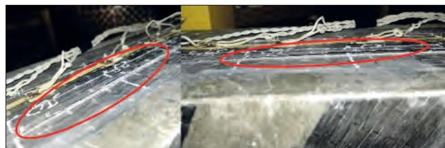
Рис. 12. Разрушение образца с отслоением углепластика
