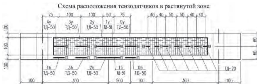
Рис. 5. Схема расположения тензодатчиков (ТД-20 – тензодатчик с базой 20 мм; ТД-50 – тензодатчик с базой 50 мм)
