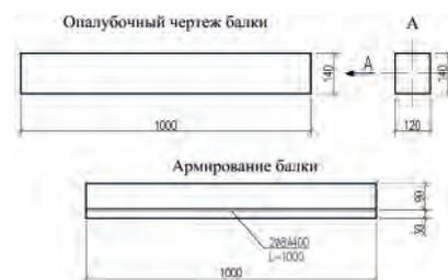
**Рис. 3.** Опалубочный чертеж и армирование балки
