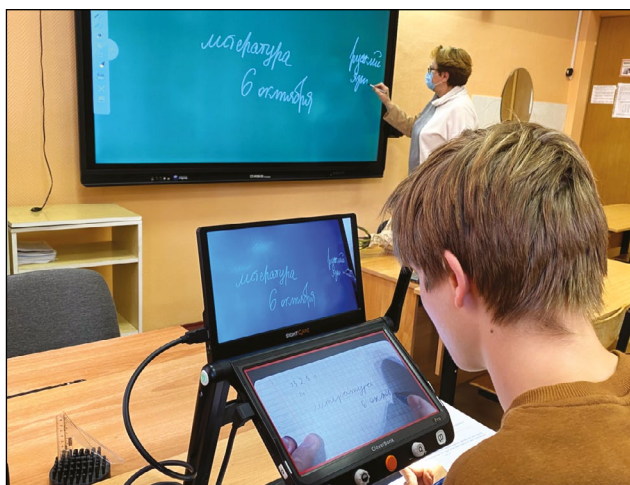
Рис. 3. Портативный видеоувеличитель Clover Book Pro с двумя экранами и двумя камерами.
